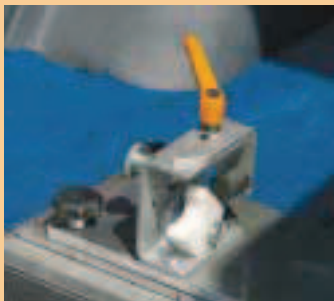
Lagerbock zur Arretierung der Rampe im Innenraum.
