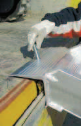
Stabiles Aluminiumauflager mit Bolzensicherung
